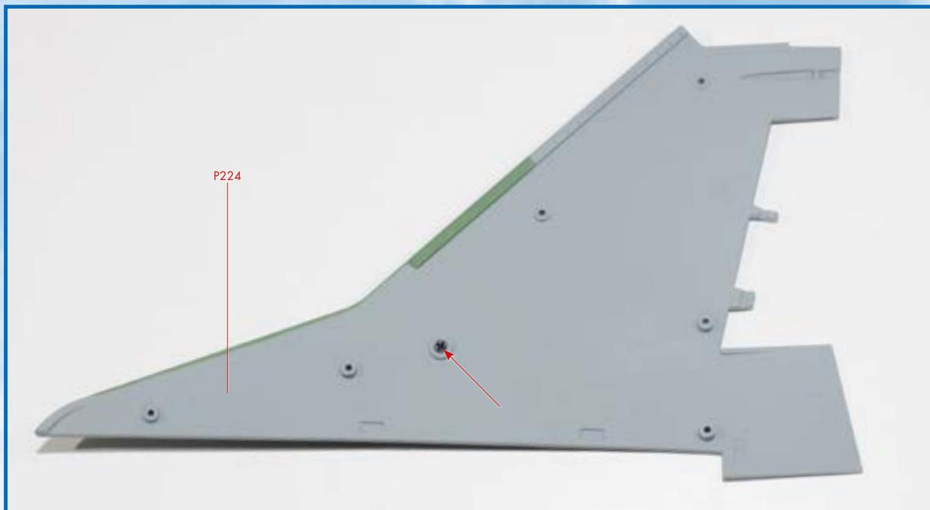
**2** Затем с обратной стороны детали P224 осторожно закрепите трубку Пито (P226) винтом LP, как показано на снимке.
